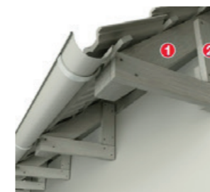
Pomocná konštrukcia z drevených dosiek
